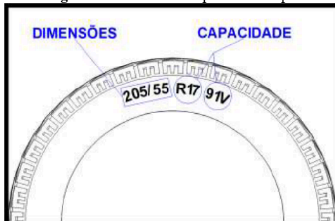
Imagem 07 Dimensões/Capacidade do pneu
