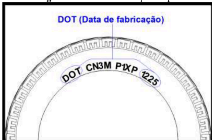
Imagem 06 Data de fabricação do pneu
